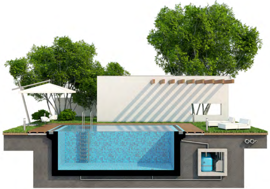
Şekil 4: Havuz tesisat galerisi
