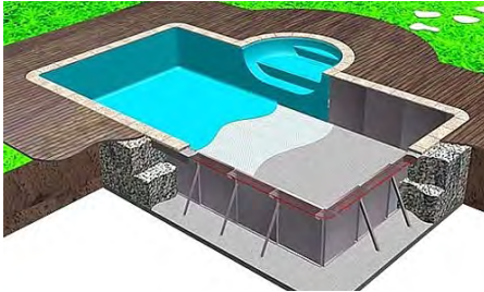
Şekil 2a: Kalıp tekniği ile imal edilen betonarme havuzlar
