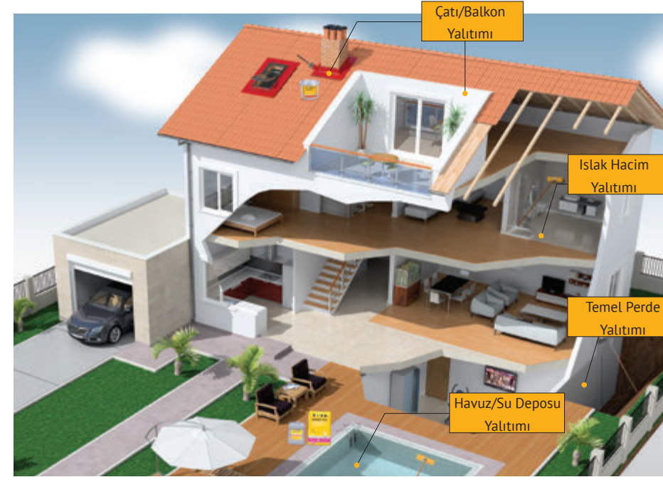
Binalarda zorunlu hale gelen su yalıtımı uygulamaları, Su Yalıtımı Yönetmeliği'nde yukarıdaki görselde işaretlenen dört ana başlık altında belirtilmiştir.
